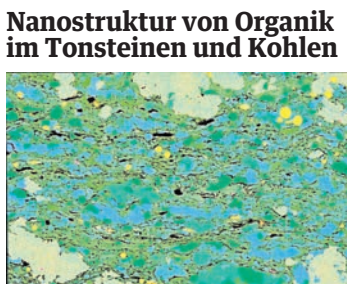
Nanostruktur von Organik im Tonsteinen und Kohlen Doris Gross nimmt Erdölmuttergestein aus 4.000 Metern Tiefe im Rasterelektronenmikroskop unter die Lupe. Dies liefert neue Erkenntnisse darüber, wie die Mikrostruktur der Organik in Tonsteinen und Kohlen das Erdölpotenzial beeinflusst.
